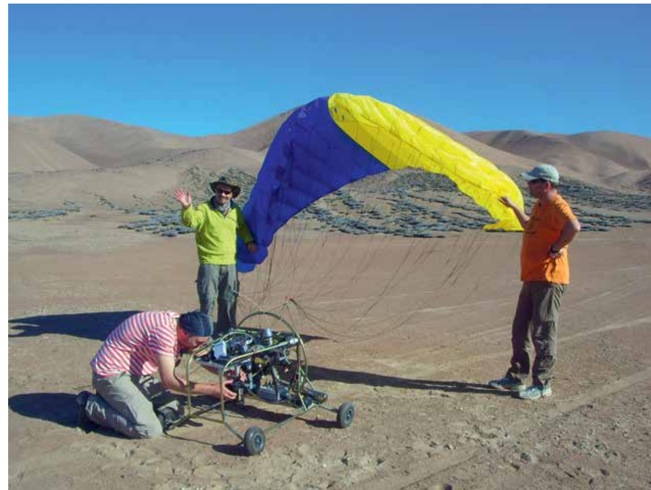
Abb. 1: Gleitschirmdrohne „SUSI 62“ mit 5,5 PS-Motor und einer maximalen Zuladung (Payload) von bis zu 8 kg an Kameras während eines Feldaufenthalts in der Atakama/Chile (Quelle: Eigene Aufnahme).
